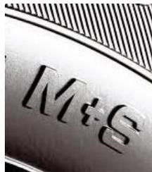
Abbildung zeigt Kennzeichnung auf einem M+S-Reifen
